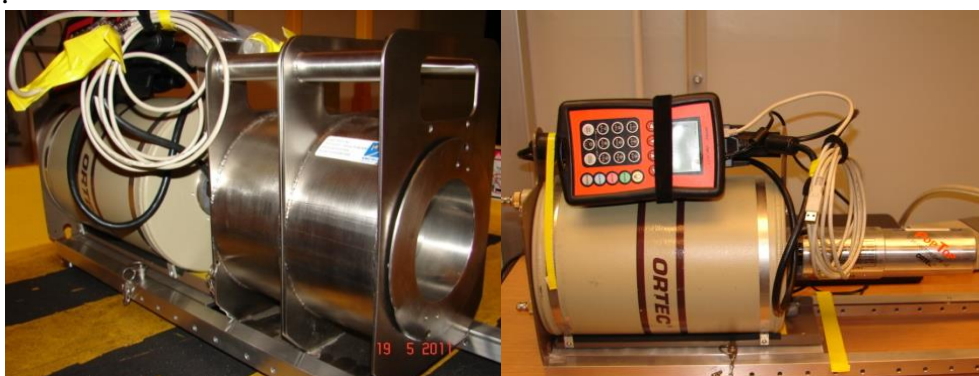
Figura 1 - Sistem \gamma -spectrometric ORTEC HpGe (cu detector de germaniu hiperpur)
